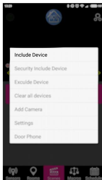
5. Контроллер перейдет на 50 секунд в режим подключения устройств.
