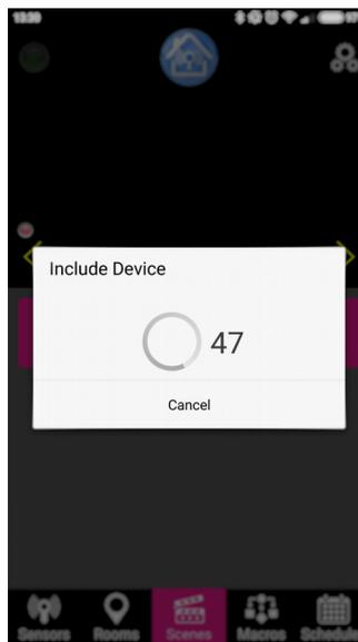
Подключение в таком режиме происходит автоматически. Как только подключение произошло, контроллер начнет автоматическую настройку устройства. Если подключение и настройка завешились успешно, появится всплывающее сообщение «Device included».
